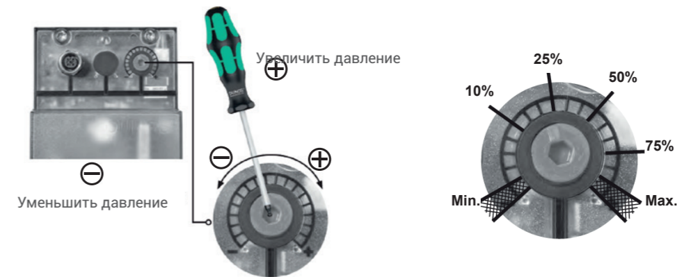
Настройка положительного давления на выходе в сочетании с PS-10/40 или PS-50/200:
