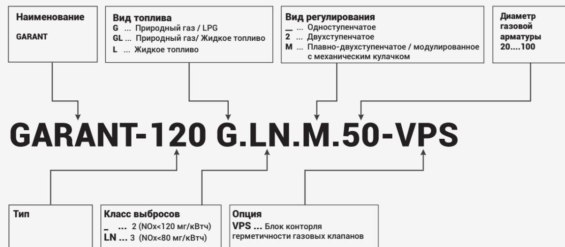
Пример условного обозначения газовой моноблочной горелки:
